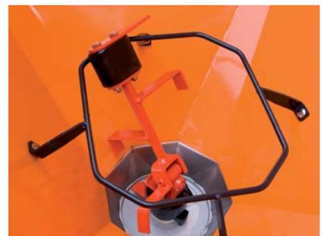
Das Rührwerk rotiert behälterschonend im Anlaufing.
